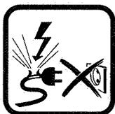
Apparat, kabel og stik skal kontrolleres før brug. Ved beskadigelse skal man lade en fagmand udskifte det beskadigede.
