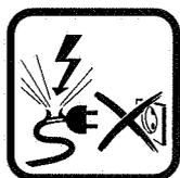
Før hver bruk må maskinen, kabelen og støpselet kontrolleres. La skader kun repareres av en fagmann.
