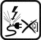
Avant toute utilisation, vérifier l'état de la machine, l'état du câble et celui de la fiche électrique. En cas de détérioration du matériel, ne faire réparer que par un spécialiste.
